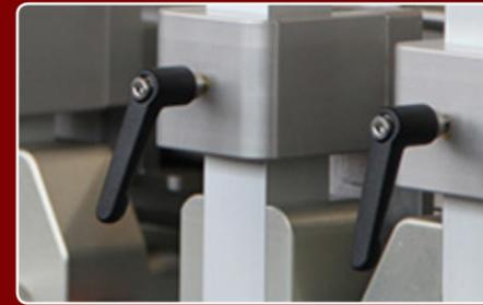
Schlittenklemmung mit Klemmhebel
